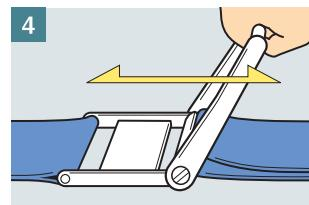
ハンドルを反復させてベルトを締め上げます。(レバーは放します)
