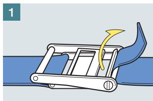
両端のフックを掛けます。両側のベルトに緩みが無くなるまで巻取り側ベルトを引っ張ります。
